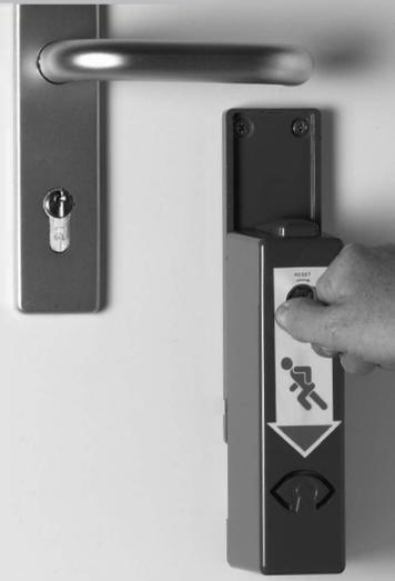
Mit dem Geräteschlüssel kann der Türwächter durch Verschieben nach unten alarmfrei in eine Dauerfreigabeposition gebracht werden. In dieser Position ist die Tür normal begehbar. Ein Daueroffenkontakt ist auf Wunsch möglich.
