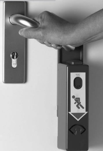
Beim Durchdrücken der Türklinke verschiebt sich der EH-Türwächter automatisch nach unten und ermöglicht in einem Öffnungsvorgang das Begehen der Notausgangstür. Dabei wird Daueralarm ausgelöst, der nur mit dem Geräteschlüssel gelöscht werden kann.
