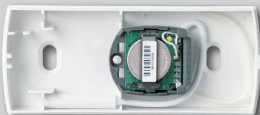
2. Die mitgelieferte Batterie CR 2032 (3 V Lithium) in den Batterieclip einschieben.
