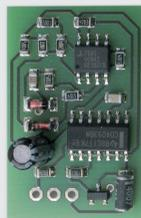
In Platine eingebaut. Bei Spannungsabfall unter 7 V ertönt für ca. 10 Tage ein Alarm.
