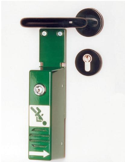
Bei 180° Ausschwenkung rastet der Türwächter ein. Die Dauerfreigabe kann alarmfrei mit dem Geräteschlüssel vorgenommen und die Tür normal begangen werden.
