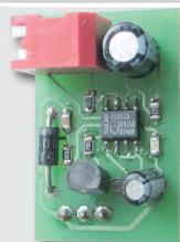
In Platine eingebaut. Abschaltzeit entweder 2 oder 6 Minuten, über einen Schalter wählbar
