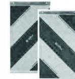
Die Montage erfolgt bei Stahlladeklappen rechts und links in den äußeren Feldern, bei Aluminiumladeklappen und verkleideten Stahlladeklappen nach Zeichnung.
