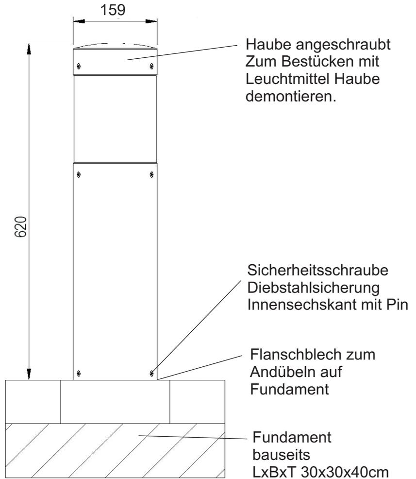
Flanschblech mit 4xBohrungen  $\text{\O}7$
