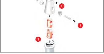
Das gebrochene Verbindungsstück wird gelöst und entfernt.
