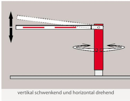
vertikal schwenkend und horizontal drehend
