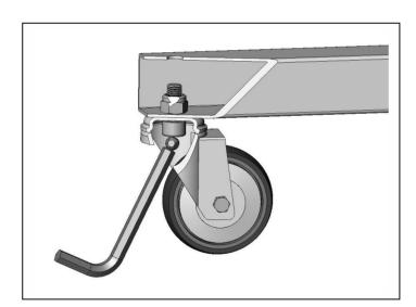
Zylinderschraube und Sechskantmutter mit passendem Werkzeug anziehen!
