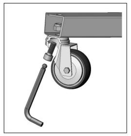
Die Zylinderschraube von unten durch den Rollenkörper einführen und Sechskantmutter von Hand fixieren!
